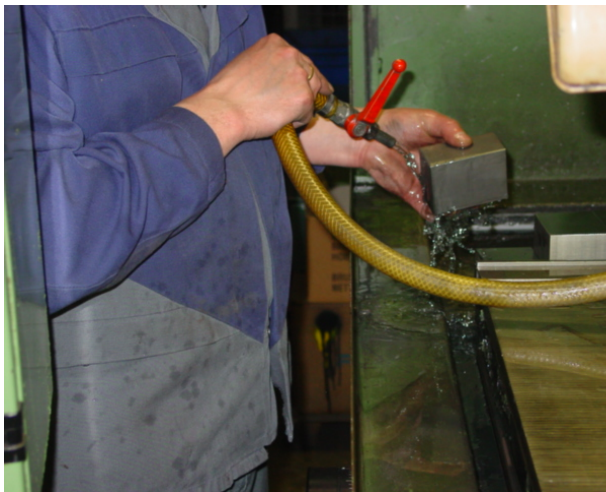
Einsatz von Kühlschmierstoff - an einer Schleifmaschine
